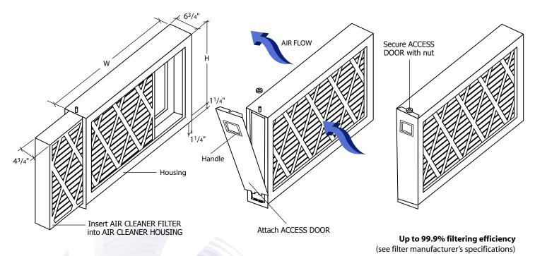
MODEL н W FILTER SIZE (filter model #) DS-1625 16" 24.75" x 15.75" x 4.25" (RF-1625) 25" DS-2025 20" 25" 24.875" x 19.75" x 4.25" (RF-2025) DS-2020 20" 20" 19.50" x 19.50" x 4.25" (RF-2020)
